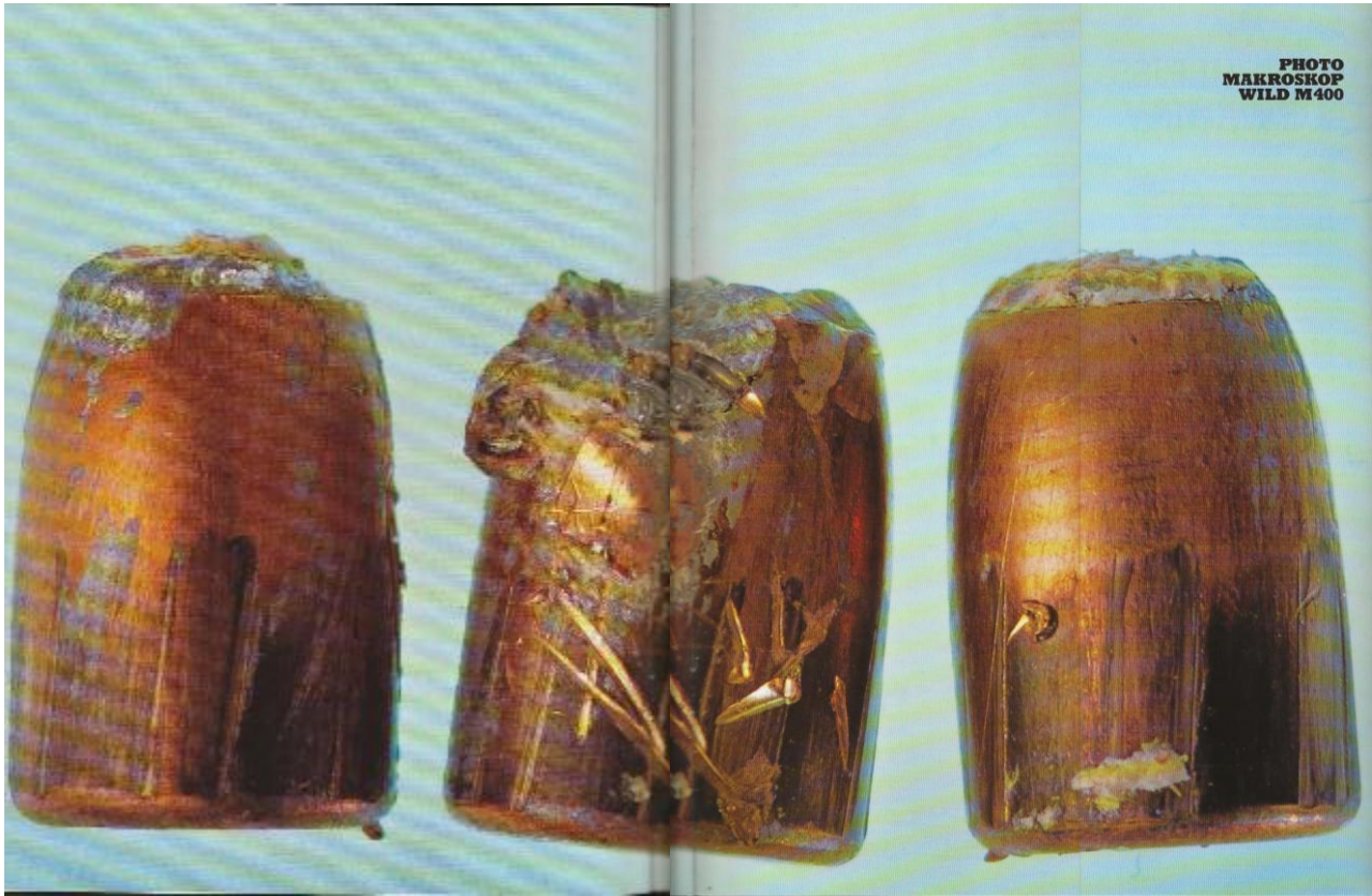
GESCHOSSE 9 mm, IN HOLZ GESCHOSSEN – ABBILDUNGS-MASSTAB IM PROSPEKT PHOTOMAKROSKOP 13,4:1
