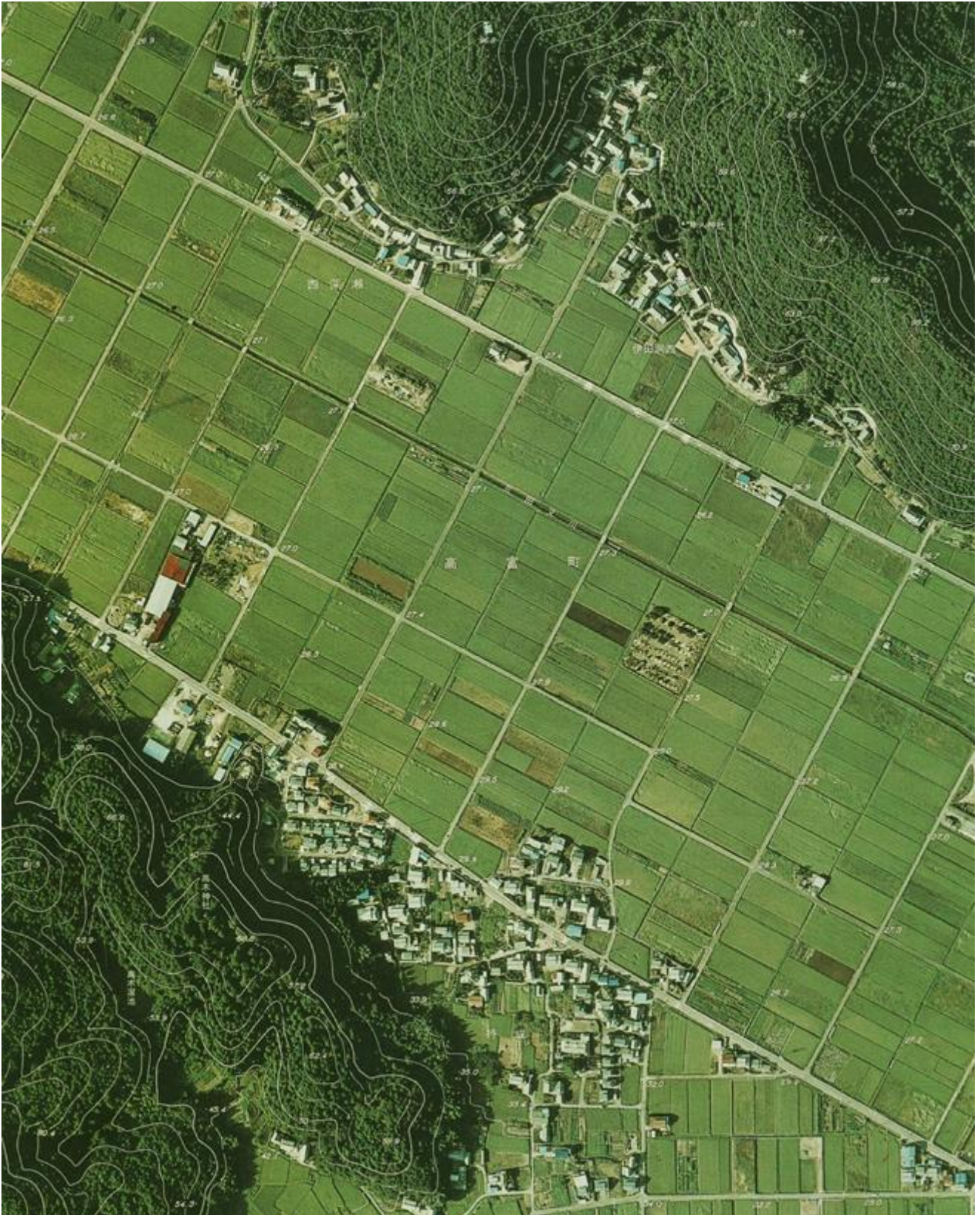
Orthophoto-Karte von Takatomicho in Japan. Hergestellt 1979 in Japan mit Photogrammetrie-Flugbildkamera Aviophot Wild RC10, Analytischem Photogrammetrie-Stereoauswertesystem Aviolyt Wild BC1, Orthophotosystem AVIOPLAN OR1 und Präzisionsplotter AVIOTAB Wild TA2.
